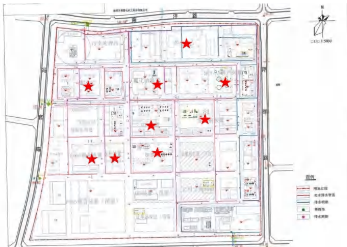
图 13.2-3 事故废水、初期雨水导排图
